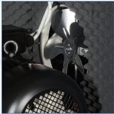
Hűtés külön elektromos ventilátorral (7,5 és 10 LE)
